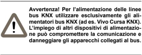
**Avvertenza! Per l'alimentazione delle linee bus KNX utilizzare esclusivamente gli alimentatori bus KNX (ad es. Vivo Cursa KNX). L'impiego di altri dispositivi di alimentazione può compromettere la comunicazione e danneggiare gli apparecchi collegati al bus.**
