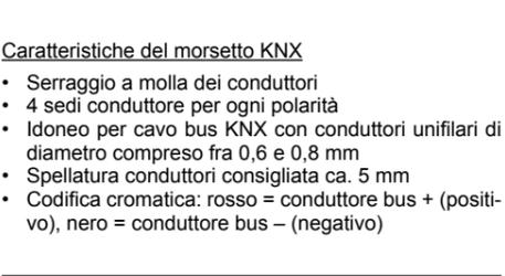
**Avvertenza!** Per l'alimentazione delle linee bus KNX utilizzare esclusivamente alimentatori bus KNX (ad es. Vivo Cursa KNX). L'impiego di altri dispositivi di alimentazione può compromettere la comunicazione e danneggiare gli apparecchi collegati al bus.
